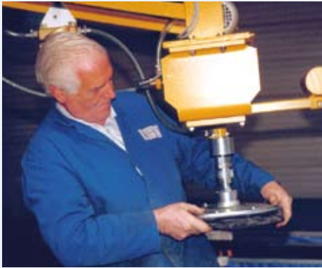
VacuBoy Mini with quick-change coupling
