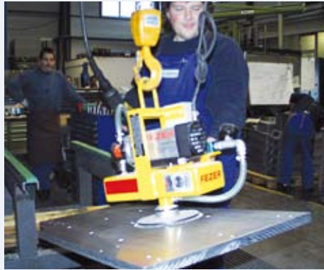
VacuBoy Mini handling sheet metal
