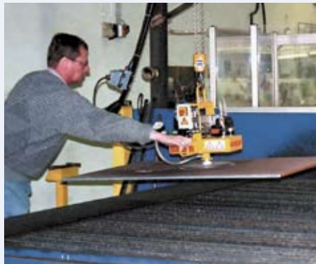
VacuBoy Mini handling steel plates
